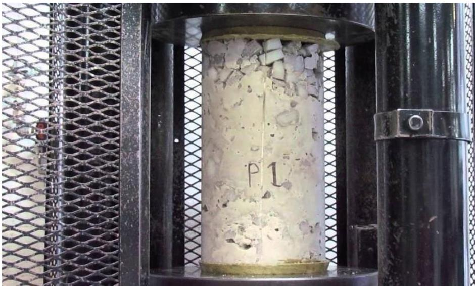
Gambar 3. 25 Ilustrasi Tes Kuat Tekan Beton
