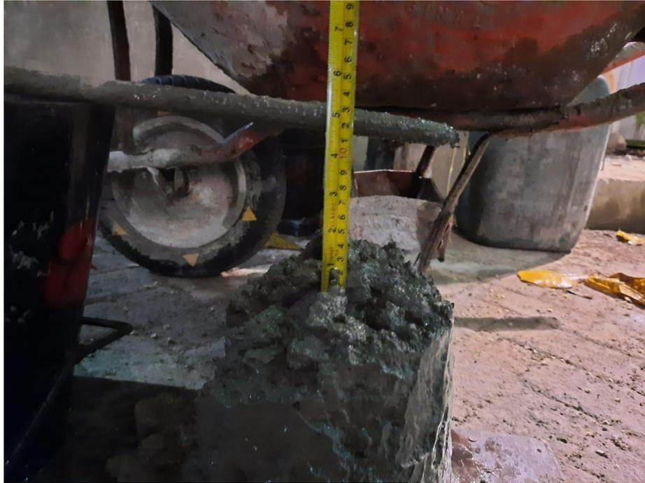
**Gambar 6. 21** Pengecekan *Slump Test*
