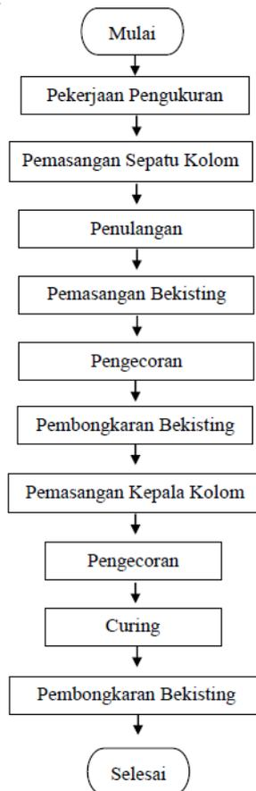
**Gambar 5. 4 Diagram Alir Pekerjaan Kolom**
