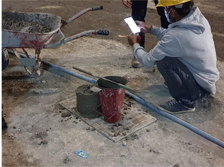
**Gambar 3. 17 Cetakan *Slump***
