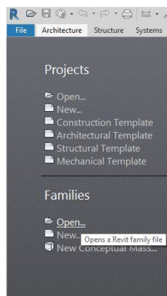
Gambar 2.29 Pembuatan File Family Baru pada Revit 2018
