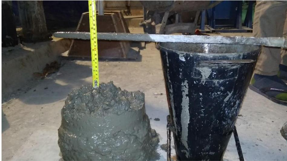
Gambar 3.4 Pengujian test slump
