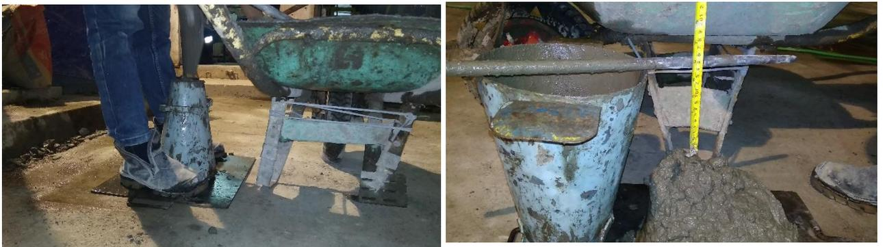
Gambar 3.13 Uji tes slump
