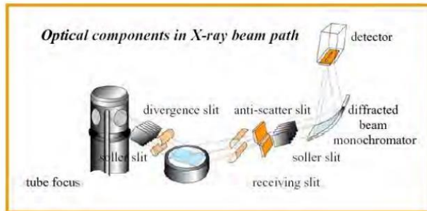
Gambar 3.8 Skema Kerja Alat XRD 51
