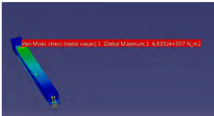
Gambar 4.8 Nodal contour untuk von mises stress dengan tegangan maksimum 68,3 MPa
