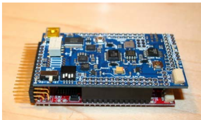
Gambar 2.26 Controller dan IMU Shield disusun menjadi unit Ardupilot Mega
