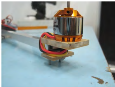
Gambar 4.20 Tiga kabel motor disalurkan melalui rongga lengan
