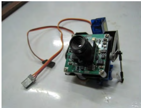
Gambar 4.30 Kamera pengamat dengan mekanisme pan-tilt rotator
