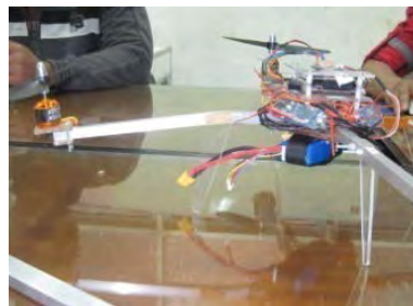
Gambar 4.17 Lengan mengalami deformasi akibat benturan pada kaki saat uji terbang
