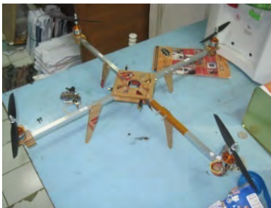
Gambar 4.16 Desain awal quadrotor menggunakan 4 kaki
