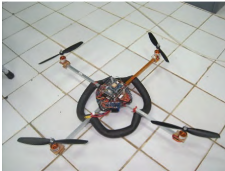
Gambar 4.13 Bentuk akhir quadrotor dengan menggunakan kaki kawat diselimuti peredam.
