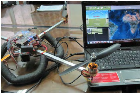
Gambar 4.21 Tampilan ArduPilot Mega Planner saat dihubungkan dengan perangkat keras.
