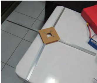
Gambar 4.14 Menyusun plat tengah dan lengan-engan Quadrotor
