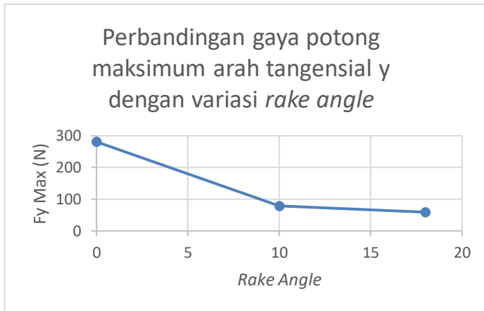
Gambar 4.2 Grafik perbandingan gaya potong maksimum arah tangensial y dengan variasi rake angle
