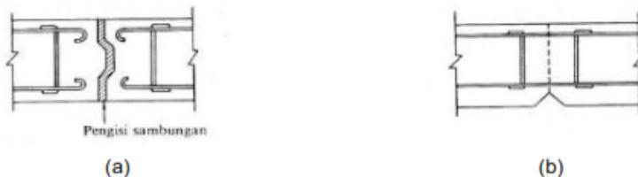
Gambar 2.8 Sambungan lepas (a) dan sambungan kontraksi (b)
