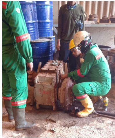
Gambar 4.5 Membersihkan Dan Mengganti Oli Turbocoupling Drag Conveyor
