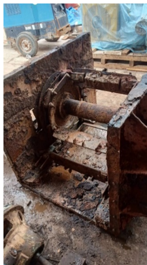
Gambar 4.6 Mengganti Sprocket Gear Drag Conveyor
