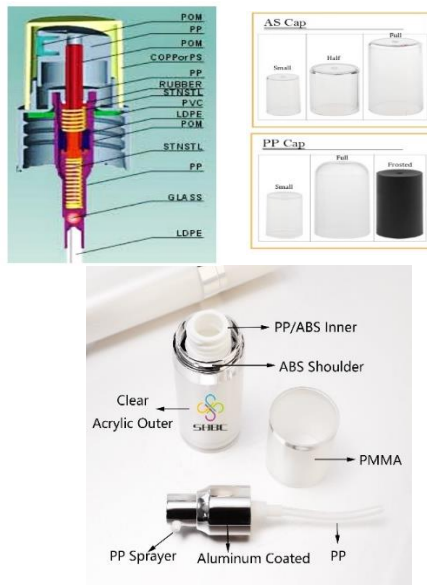
Gambar 4.11 Spesifikasi Kemasan Pompa Plastik
