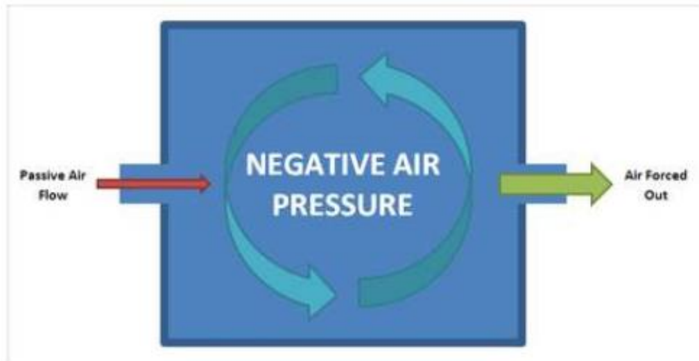
Gambar 2.1 Airflow ruangan isolasi bertekanan negatif
