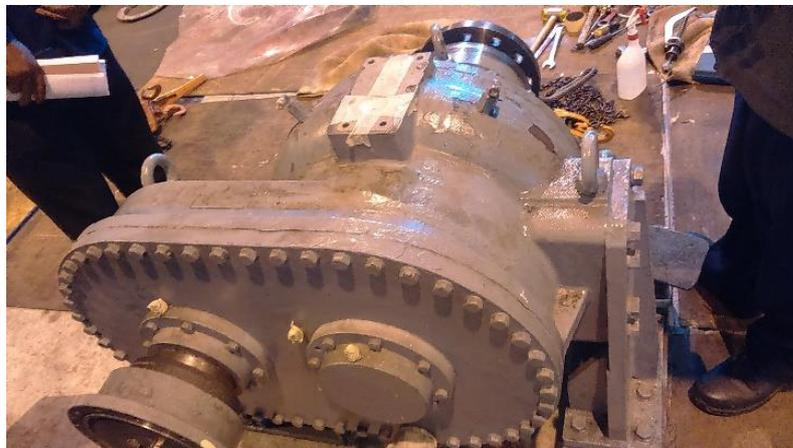
Gambar 4.5. Torque Converter yang Ada Di PLTGU PJB Gresik
