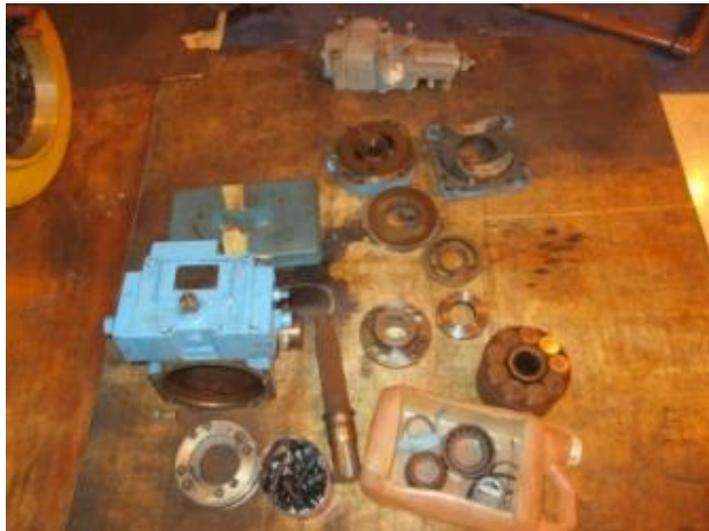
Gambar 4.11. Main Control Oil Pump (MCOP) pada PLTGU PJB Gresik
