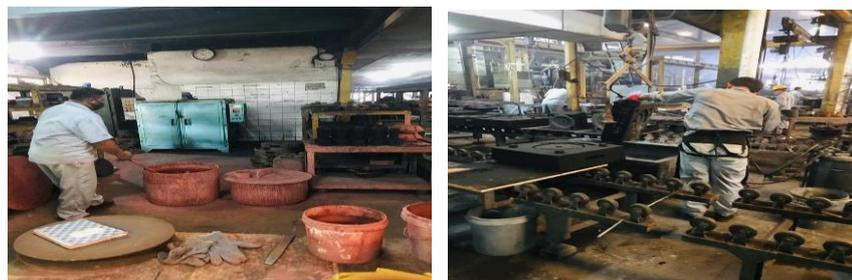
Gambar 1. 5 Proses Coating dengan Zat Pelarut Air dan Zat Pelarut Metahnol
