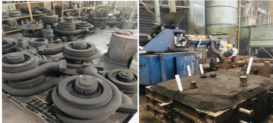
Gambar 1. 4 Proses Pembuatan Molding dan Core
