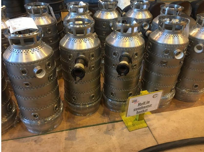
Gambar 3.5. *Combustion Basket Pada Saat Overhaul*
