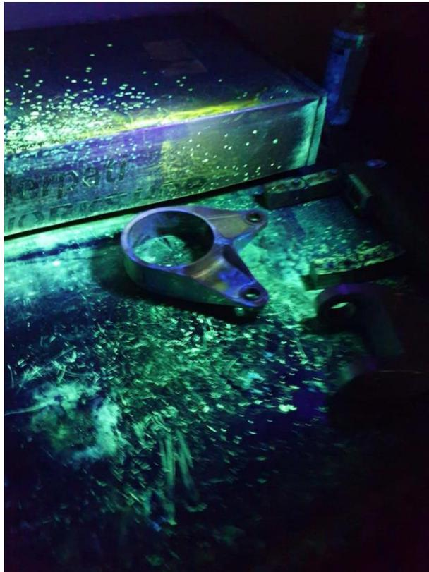
Gambar 3.2 Hasil pengujian NDT pada *Nose Landing Gear Top Attachment*
