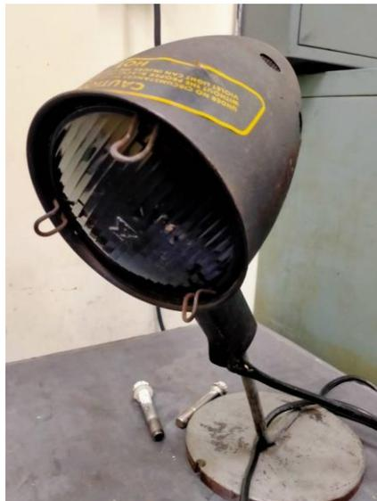
Gambar 2.9 Sinar *UV Lamp* untuk Pengujian *NDT*
