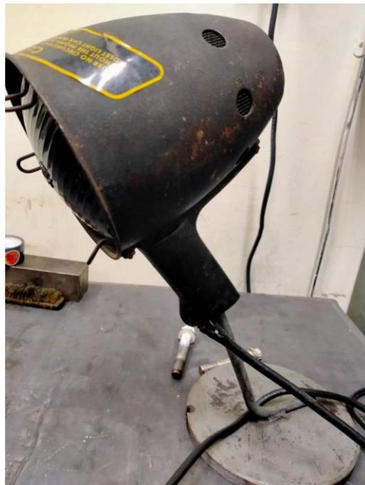
Gambar 4.1 *NDT UV Lamp* yang digunakan saat inspeksi
