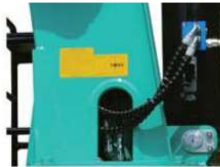
Gambar 2.57 Komponen Over Center Valve
