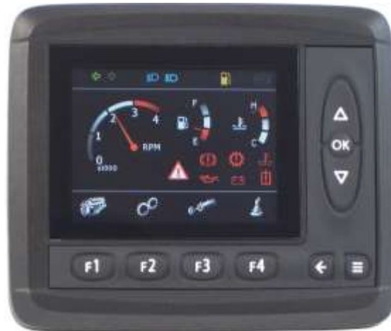
Gambar 2.50 Sistem kontrol IQAN MD3
