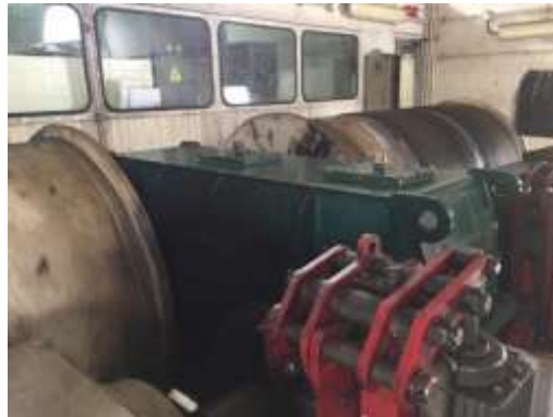
Gambar 2.35 Gambar Hoist gearbox Spesifikasi Hoist gearbox :
