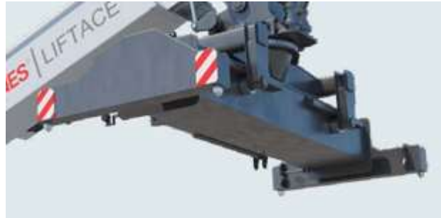
Gambar 2.51 Komponen Spreader pada Stacker Crane
