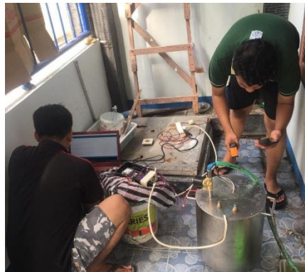
Gambar 4.34 Pengujian Sistem Kendali PID pada Pemanas Air Otomatis
