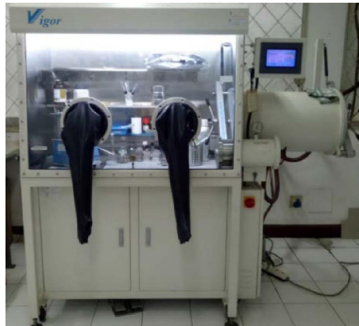
Gambar 3.2 Glove Box untuk Assembly Baterai
