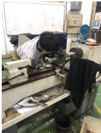
Gambar 5. 22 Proses Pengerjaan Bubut Pada Tabung Jetclean
