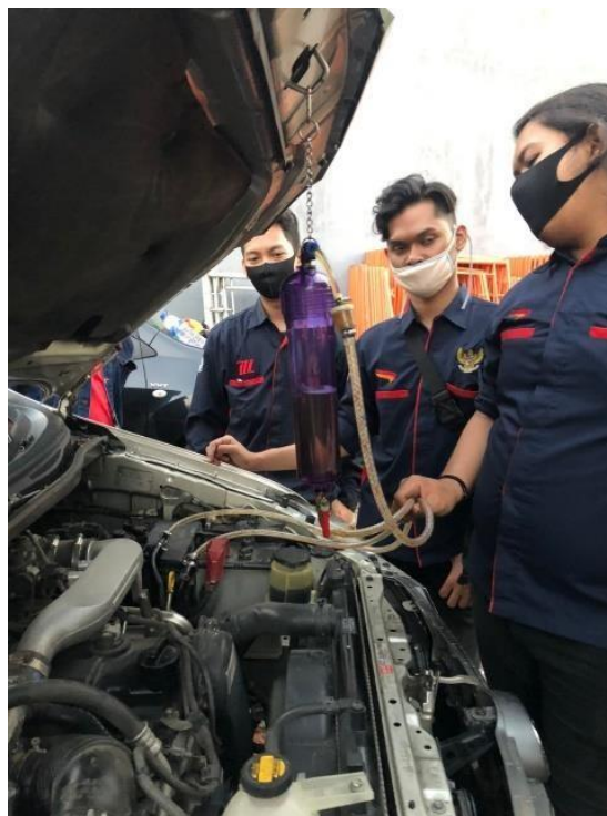
Gambar 5. 8 Diesel Purging pada Mobil
