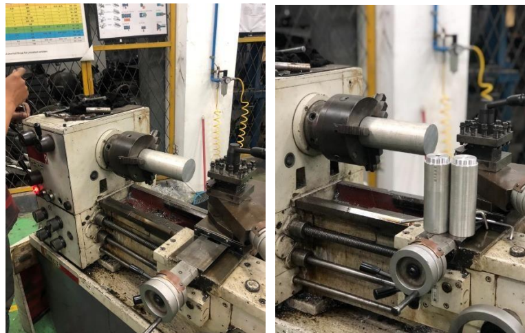
Gambar 5. 23 Progres pengerjaan bubut pada tabung jetclean
