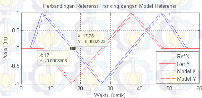
Gambar 4.9 Perbandingan Referensi Tracking dengan Model Referensi untuk Gerak Quadrotor
