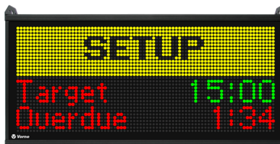
Gambar 5.3 Display untuk monitor waktu changeover
