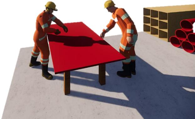
**Gambar 8.2** Fabrikasi Profil Plat tebal 25 mm
