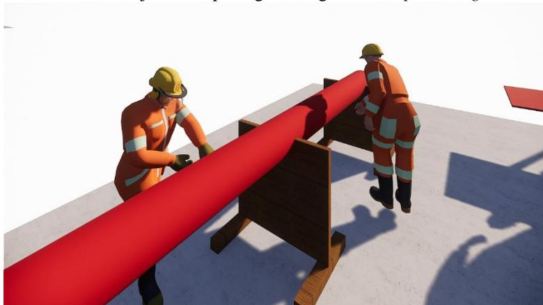
**Gambar 8.1** Fabrikasi Profil Baja HSS untuk Elemen Bresing
