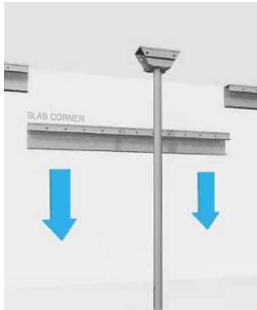
Gambar 4.16 Pembongkaran Pada Sudut Slab Sumber: Dokumen PT. PP
