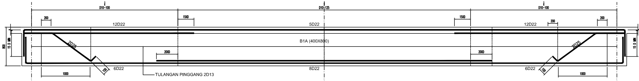
DETAIL PENULANGAN BALOK B1A SKALA 1:25
