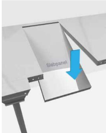
Gambar 4.15 Pembongkaran Panel Slab Sumber: Dokumen PT. PP
