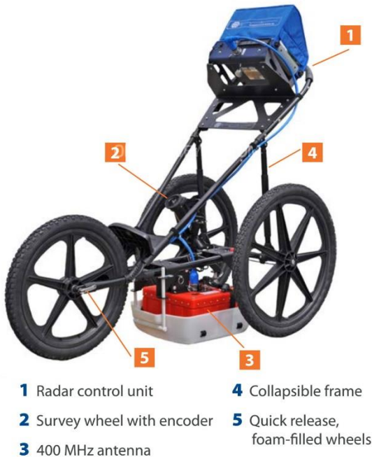
Gambar 2.3 Komponen/peralatan GPR GSSI 3000
