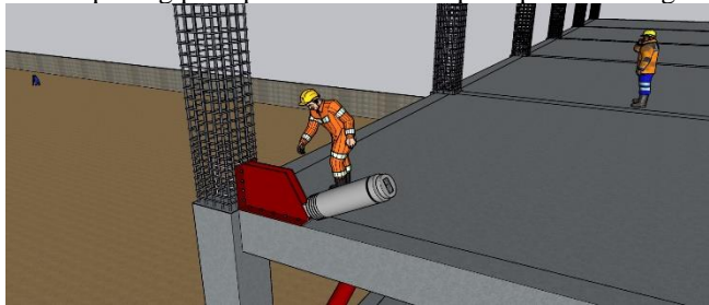
Gambar 7.4 Pemasangan Baut Pada Plat Sambung
