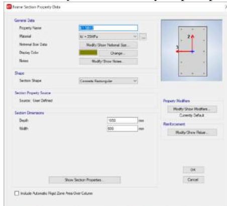
Gambar 3.17 Frame Section Property Data untuk Kolom
