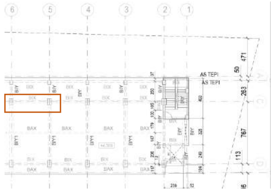
Gambar 6.2 Balok yang Ditinjau
