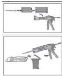
Gambar 7.43 Pekerjaan Persiapan untuk Injeksi Sumber : HILTI
