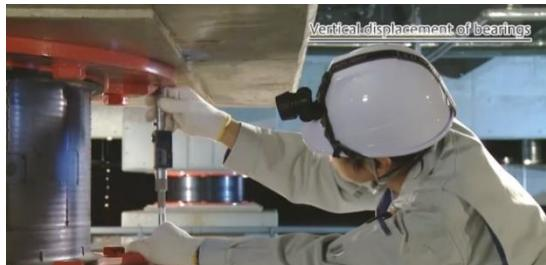
Gambar 10-20. Pengecekan Perpindahan Vertikal
