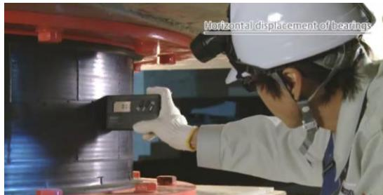
Gambar 10-19. Pengecekan Perpindahan Horizontal
