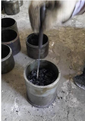
Gambar 3.e Pematatan benda uji menggunakan alat compactor
