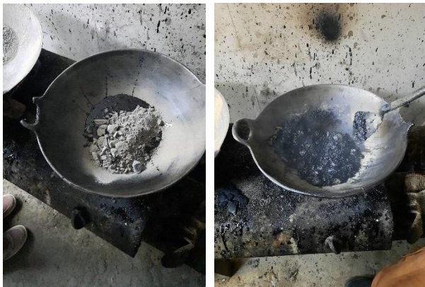
Gambar 3.d Pencampuran Aspal + Crumb Rubber yang sudah homogen dengan Agregat
