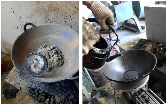
Gambar 3.c Pemanasan Agregat dan Aspal diatas kompor
