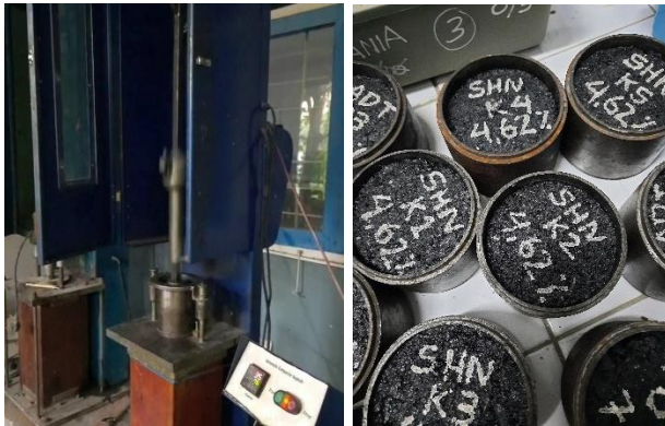
Gambar 3.e Pematatan benda uji menggunakan alat compactor
