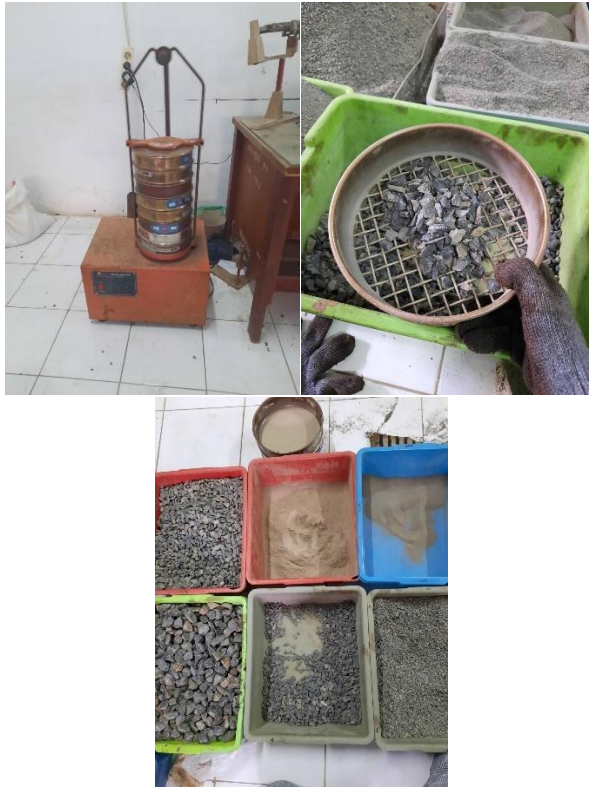
Gambar 1.a Proses Analisa Ayakan
