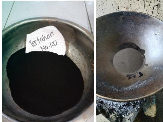
Gambar 3.d Pencampuran Aspal dengan Crumb Rubber sampai homogen
