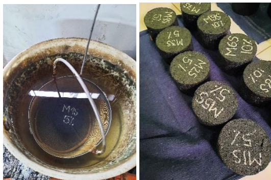
Gambar 3.f Perendaman dalam waterbath dan pengujian Marshall
