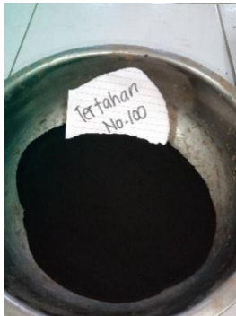
Gambar 3.a Material Crumb Rubber untuk pembuatan benda uji
