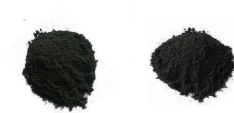
Gambar 3. 4 Modifikasi Crumb Rubber (Mesh 40) dan (Mesh 60)
