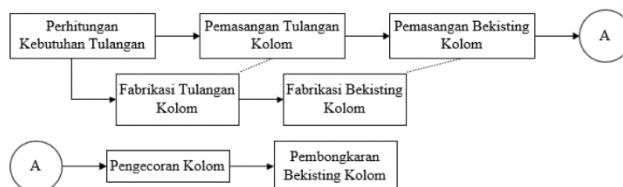
**Gambar 2. 1** Bagan Alur pekerjaan Kolom
