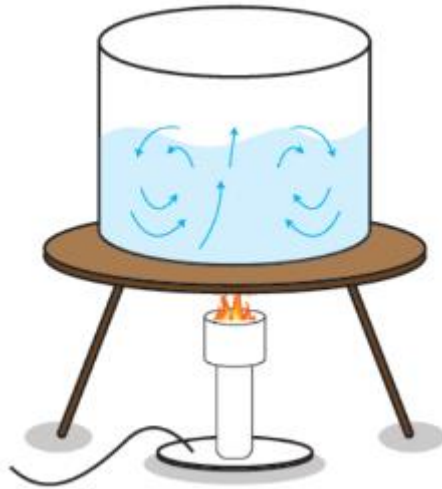
Gambar 2.4 Perpindahan Panas secara konveksi (Nizar,2019)
