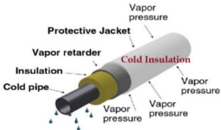
Gambar 2.30 Detail untuk insulasi dingin (whatspiping, 2021)
