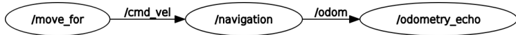
Gambar 4.3: Relasi antar- node dari pengujian gerakan linier dan estimasi posisi pada real robot .
