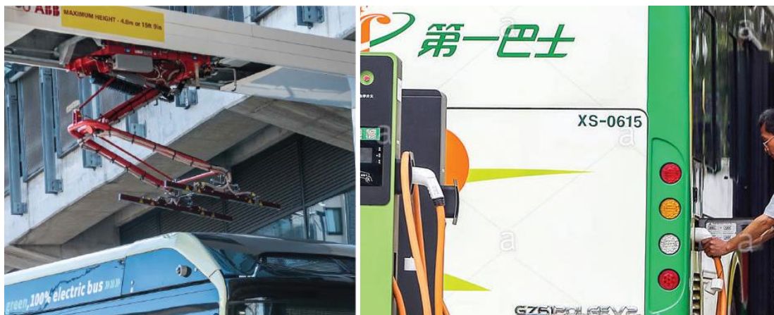
Gambar 2.10 Conductive charging Sumber : chargedevs.com ,Diakses pada Januari 2021.
