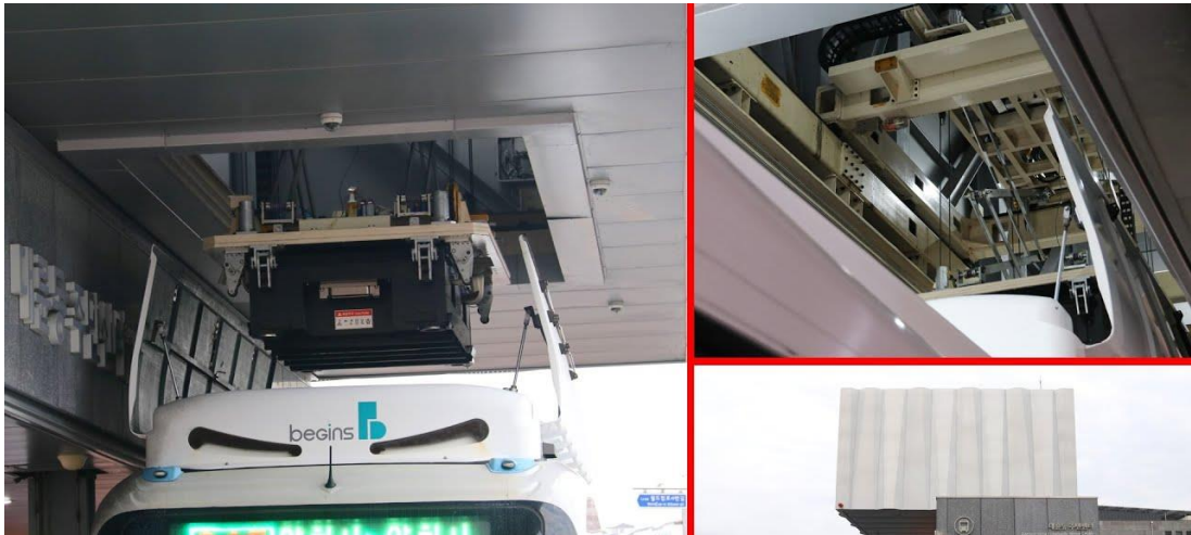
Gambar 2.11 FIBRID bus battery swap Sumber : kojects.com, ,Diakses pada Januari 2021.
