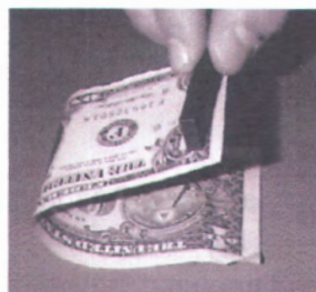
Gambar 2.6 Pendeteksian keaslian uang dollar Amerika dengan menggunakan magnet
