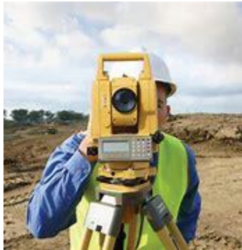
Gambar 4. 3 Penentuan titik menggunakan total station
