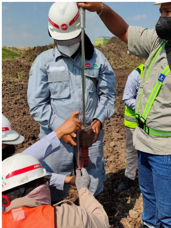
Gambar 4. 11 Penumbuk yang Diangkat pada Proses Pengujian DCP Test
