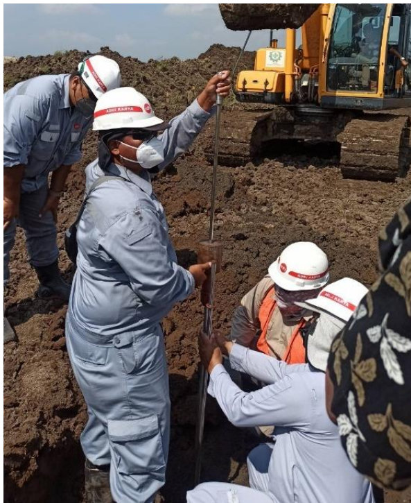
Gambar 4. 10 Penempatan Alat DCP Test pada Titik Uji
