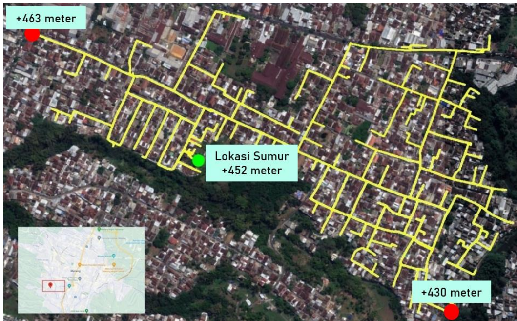
Gambar 2.5 Peta Jaringan Perpipa-an Sistem Distribusi Sumbersari
