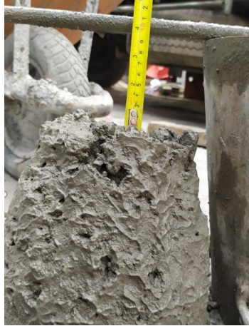
Gambar 4. 1 Tes Slump Beton
