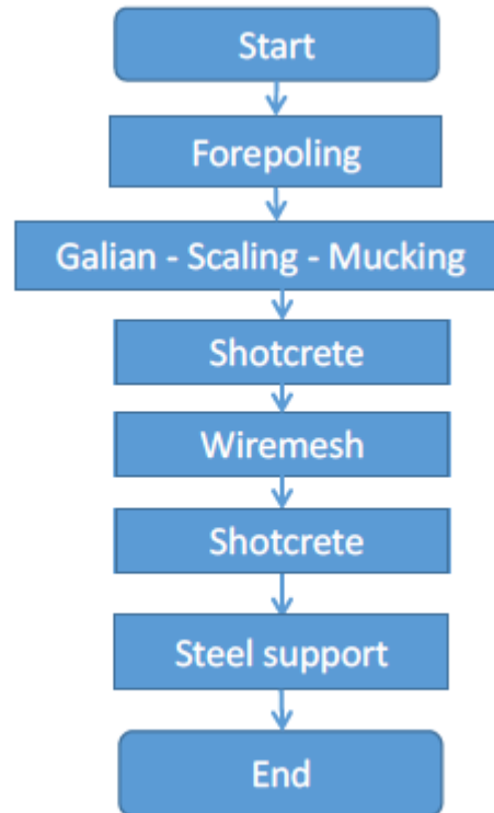
Gambar 3. 4 Flowchart Urutan Pekerjaan Galian Tunnel Pengelak Secara Mekanis
