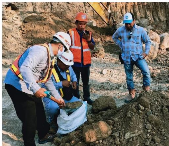
Gambar 3. 8 Proses Pengambilan Sampel Tanah di Quarry Sobokerto
