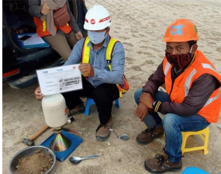
Gambar 3. 11 Kegiatan Sandcone Test Untuk Mengetahui Nilai Kepadatan Tanah
