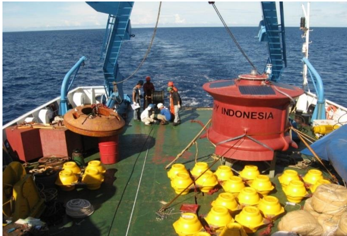
Gambar 4.23 Pemasangan InaTEWS Buoy Generasi ke 2 di Selatan Lampung, 2008
