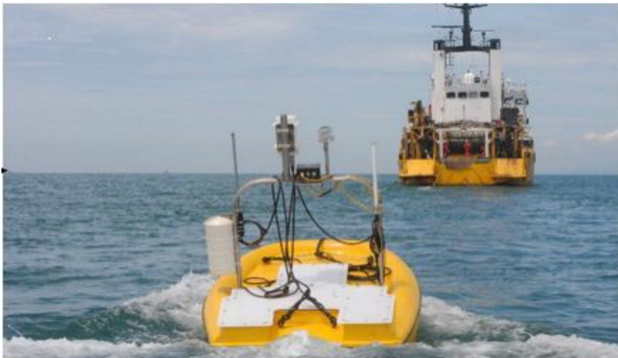
Gambar 3.28 Tail Buoy Dengan Control Ruder Hasil Inovasi Balai Teksurla, 2010
