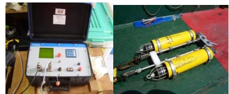
Acoustic Release : Deck unit (kiri) Underwater unit (kanan)
