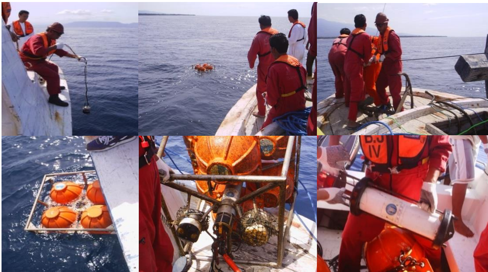
Gambar 4.6 Survei Pengukuran Arus untuk Potensi Energi Arus Laut di Selat Alas-NTB dan Ceningan-Bali, dengan KR. Baruna Jaya I, 2006
