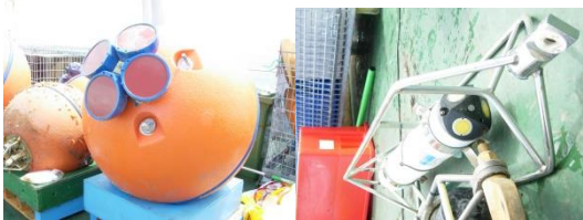
Instrument mooring : ADCP RDI (kiri) dan Sontek Argonaut-MD (kanan)
