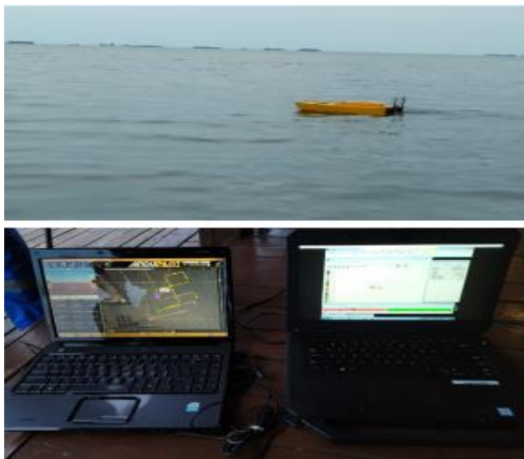
Gambar 3.30 Kontrol Dan Pengawasan Olah Gerak Wahana Dari Sistem Arduino Pilot Dan Hasil Uji Akuisisi Kedalaman Perairan
