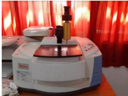
**Gambar 3.3** Alat Pengujian FTIR
