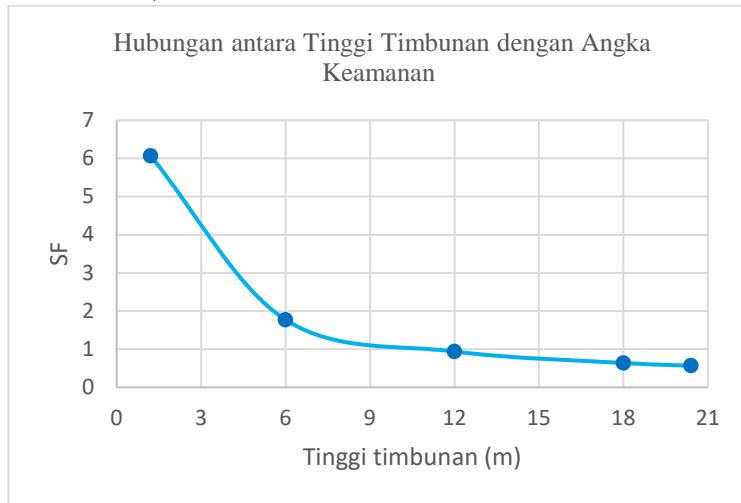
Gambar 5.17 Grafik hubungan antara tinggi timbunan dan angka keamanan terhadap daya dukung tanah
