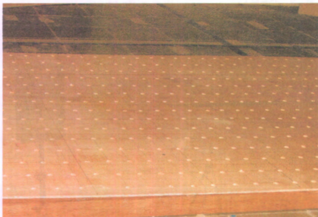
Gambar 4.2 Tripleks dengan perforasi 3 % diameter lubang 10 mm di atas kerangka 4 cm dari lantai.
