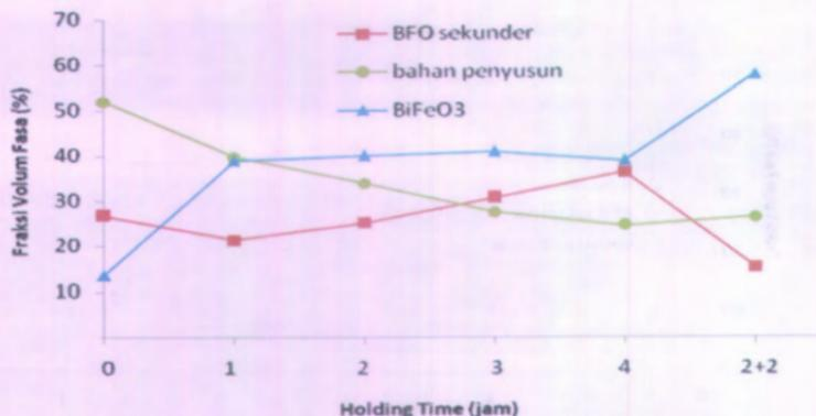
Gambar 4.14 Grafik prosentase fraksi volum fasa yang terbentuk pada sampel dengan suhu  $750^{\circ}\text{C}$  berbahan dasar Fe, *holding time* 1 jam, 2 jam, 3 jam, 4 jam, dan 2+2 jam dengan  $x=0,5$
