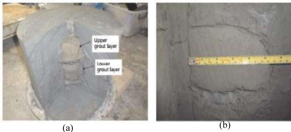
**Gambar 2.13** (a) Penampakan Upper dan Lower Grout Layers Setelah Lapisan Tanah Lunak Dihilangkan, (B) Pengukuran Jarak Jangkauan Grouting
