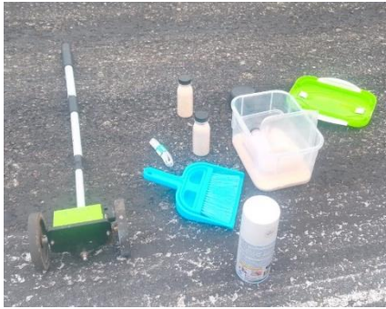
Gambar 5. 10 Alat dan bahan sand patch test dan pengukuran titik
