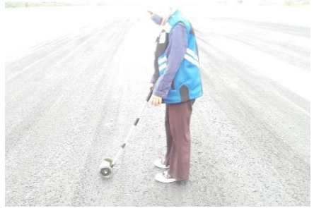
Gambar 5. 10 Alat dan bahan sand patch test dan pengukuran titik
