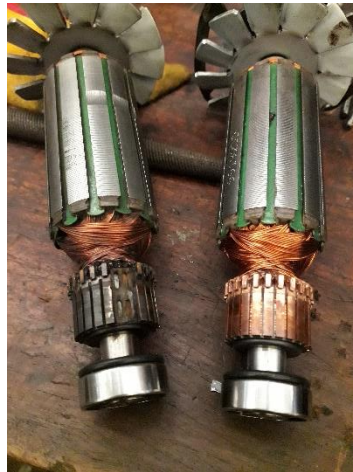
Gambar 3.1 Perbedaan Rotor Gerinda yang Rusak dan Kondisi Normal
