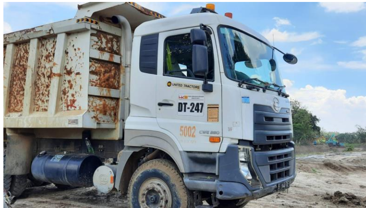
Gambar 4. 9 DT 247 Quester 22 ton, CWE 280 (Sumber: Dokumentasi Pribadi)
