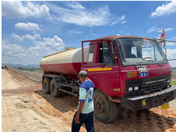
Gambar 4. 15 Water Tank Kapasitas 5000L (Sumber: Dokumentasi Pribadi)
