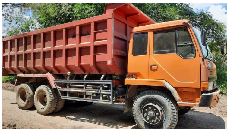
Gambar 4. 13 AT 08 Mitsubishi 22 ton, 220 PS (Sumber: Dokumentasi Pribadi)
