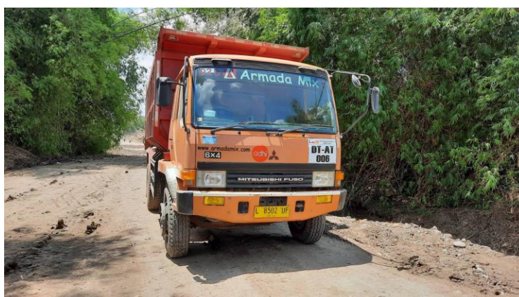
Gambar 4. 12 AT 06 Mitsubishi 22 ton, 220 PS (Sumber: Dokumentasi Pribadi)
