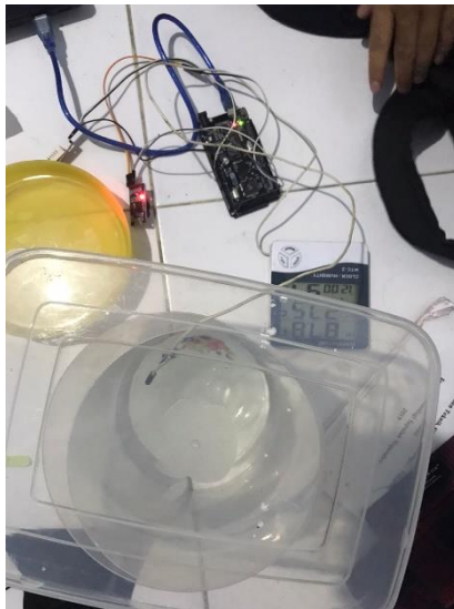
Gambar 4. 2 Kalibrasi Sensor DHT 22 dan HTC-2
