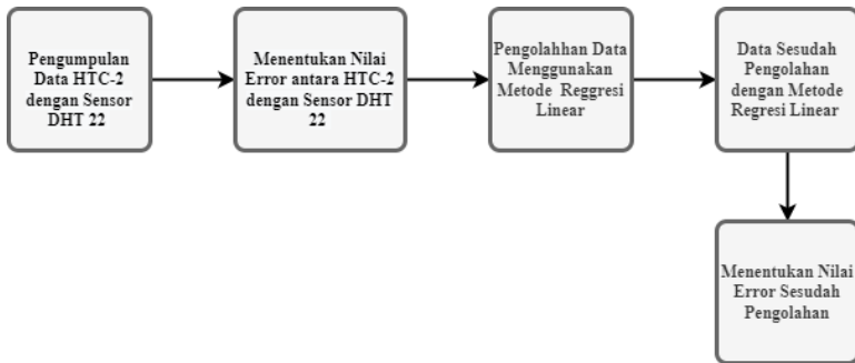
Gambar 3. 2 Tahap Penggunaan Metode Regresi Linear Pada Sensor DHT 22
