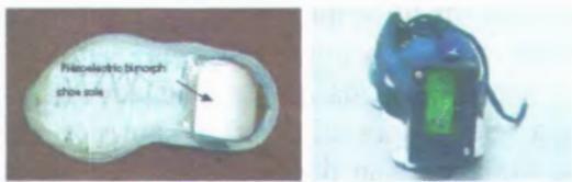
Gambar1.1. Piezoelectric yang disisipkan di sol sepatu
