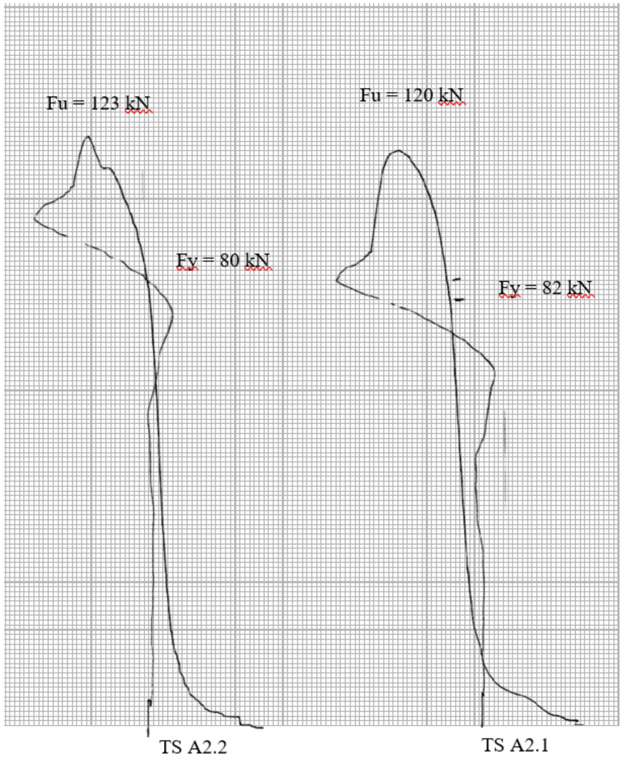
Lampiran 3.2 Grafik Uji Tarik Test Piece A2
