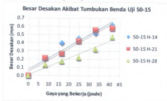
Gambar 4.62. – Grafik Hasil Pengujian Tumbukan Benda Uji Kuat Tekan 50 MPa dengan 15% Fly Ash
