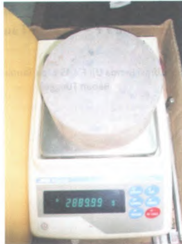
Gambar 4.27. – Benda Uji Ditimbang setelah Diuji Abrasi
