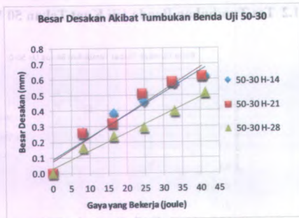
Gambar 4.63. – Grafik Hasil Pengujian Tumbukan Benda Uji Kuat Tekan 50 MPa dengan 30% Fly Ash
