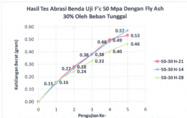
Gambar 4.42. – Grafik Tes Abrasi Benda Uji f'c 50 dengan 30% Fly Ash MPa Oleh Beban Tunggal
