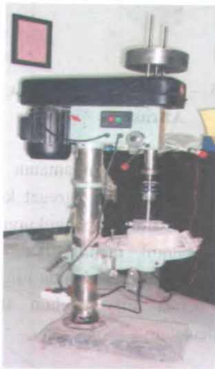
Gambar 4.22. – Pengujian Abrasi dengan Beban Tunggal
