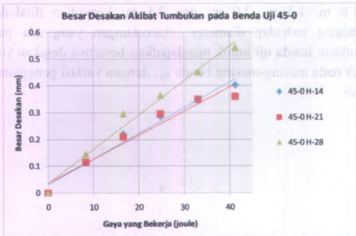
Gambar 4.56. – Grafik Hasil Pengujian Tumbukan Benda Uji Kuat Tekan 45 MPa Tanpa Fly Ash
