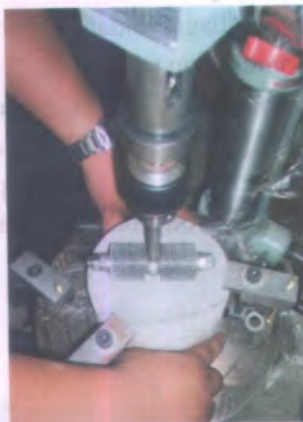
Gambar 4.23. – Pemasangan Benda Uji pada Alat Abrasi
