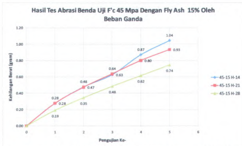
Gambar 4.31. – Grafik Hasil Tes Abrasi Benda Uji F'c 45 MPa dengan Fly Ash 15% Oleh Beban Ganda
