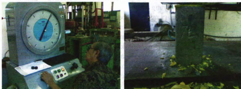
Gambar 3.5 foto tes kuat tekan dan proses tes kuat tekan
