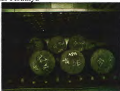
Gambar 3.2 beton kedap air saat di oven
