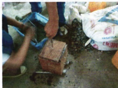
Gambar 4.32 proses akhir pencetakan pemberat terapung
