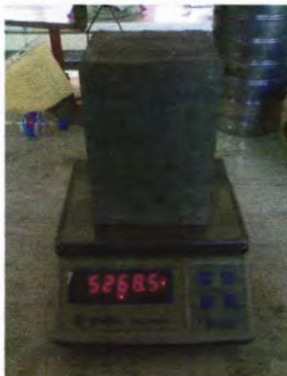
Gambar 4.35 pengukuran berat prototype pemberat terapung
