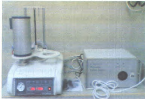
Gambar 3.2 Seperangkat alat uji Thermal Analysis (TA) di Laboratorium Jurusan Fisika FMIPA Universitas Negeri Malang.
