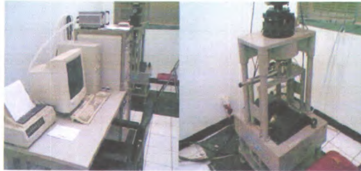
Gambar 3.5 Seperangkat alat uji Vibrating Sample Magnetometer (VSM) tipe OXFORD VSM1.2H (BATAN).
